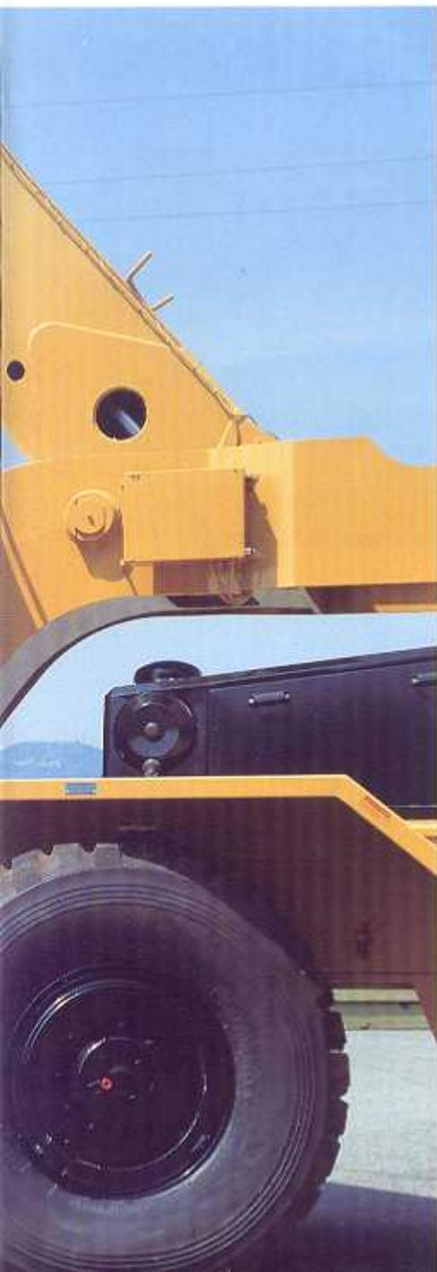
**Tourelle:** Construction en acier à haute résistance, entièrement soudée.
